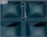
Stecken Sie den Befestigungsdorn in das Loch in der Mitte der Blende und der G-WALL Zelle. Vergewissern Sie sich, dass dieser fest einrastet.
